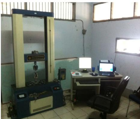
**GAMBAR 9** Mesin Uji Tarik
