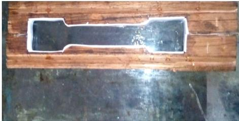
**GAMBAR 1** Cetakan specimen
